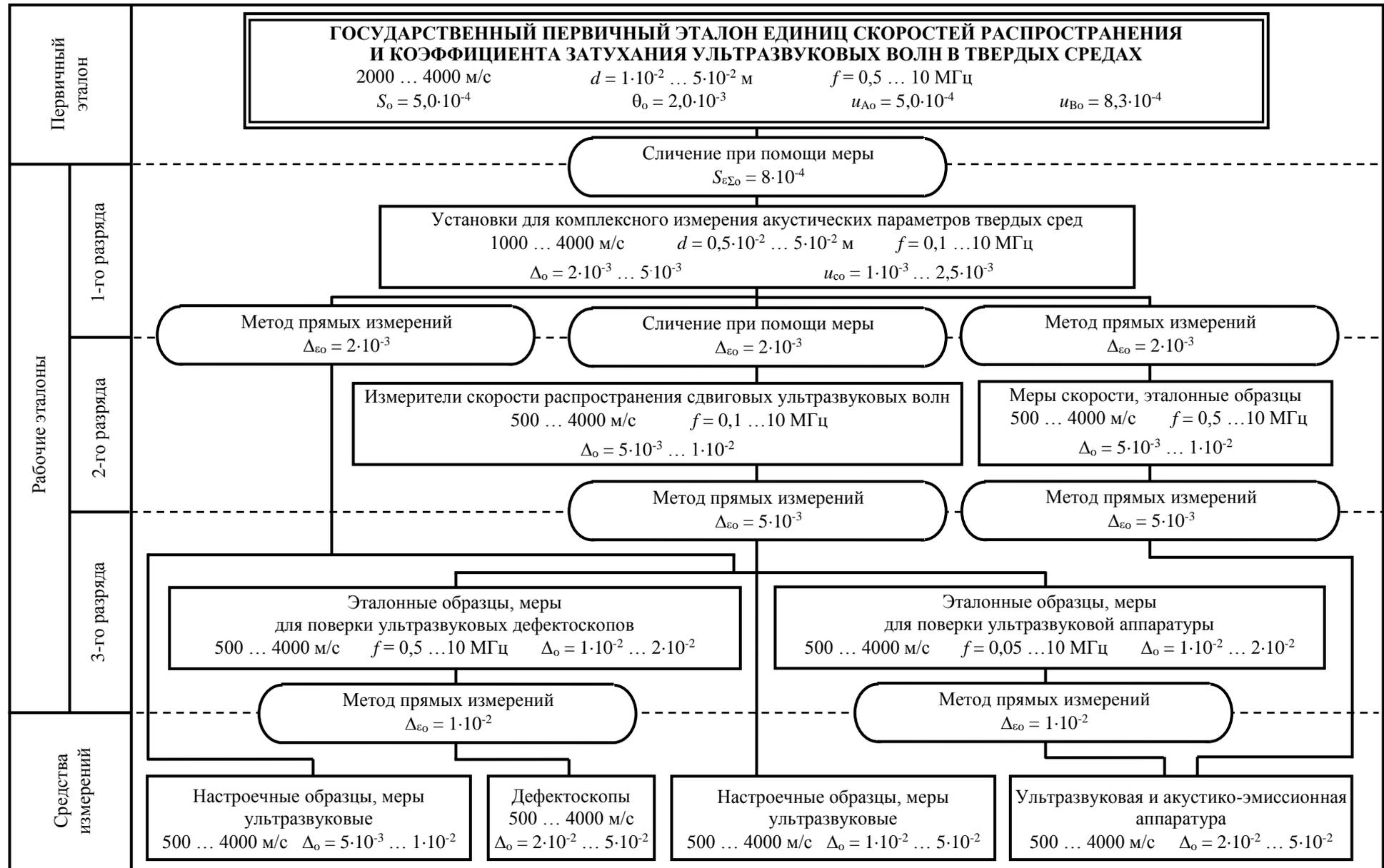
Государственная поверочная схема для средств измерений скоростей распространения и коэффициента затухания ультразвуковых волн в твердых средах
