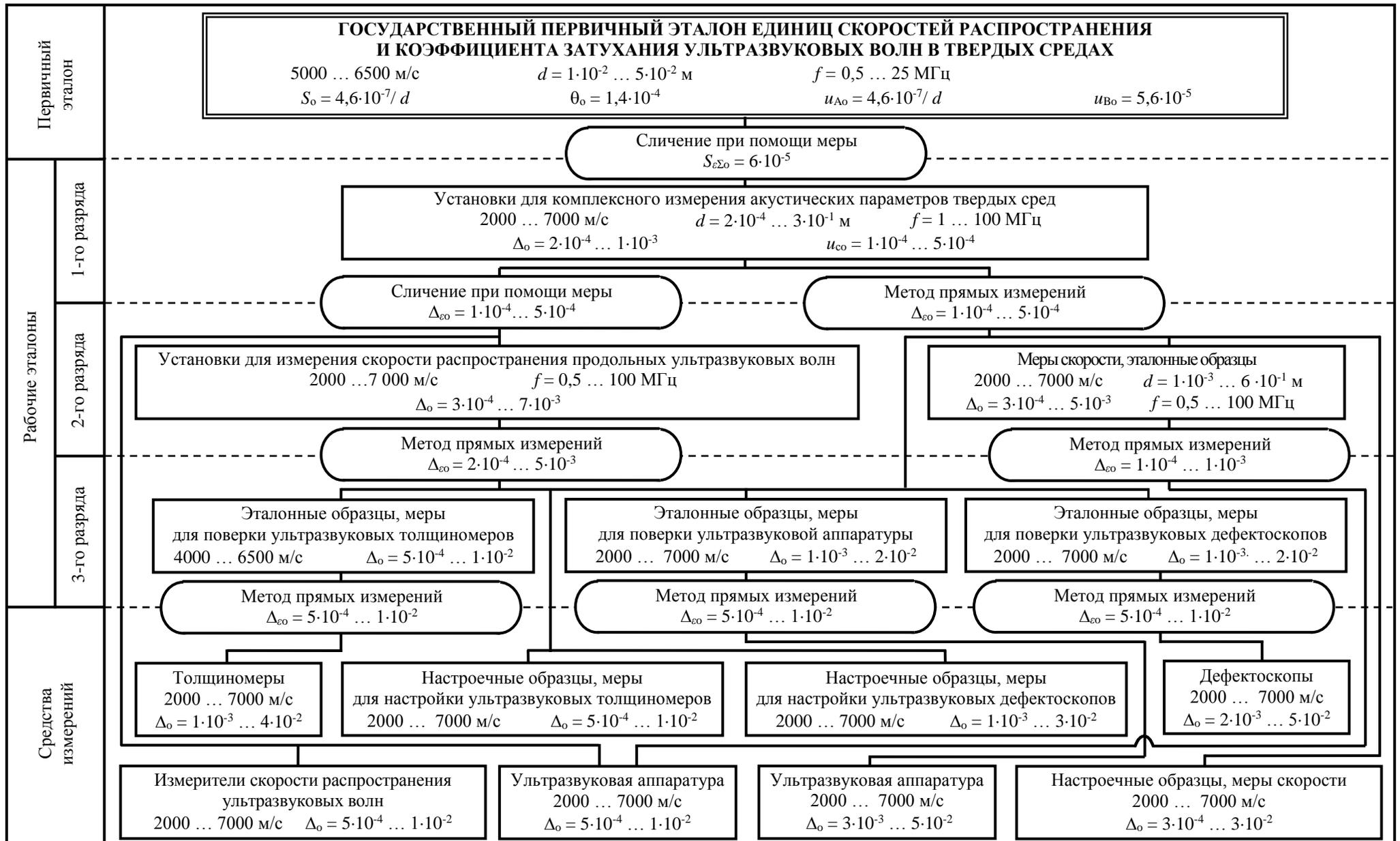
Государственная поверочная схема для средств измерений скоростей распространения и коэффициента затухания ультразвуковых волн в твердых средах
