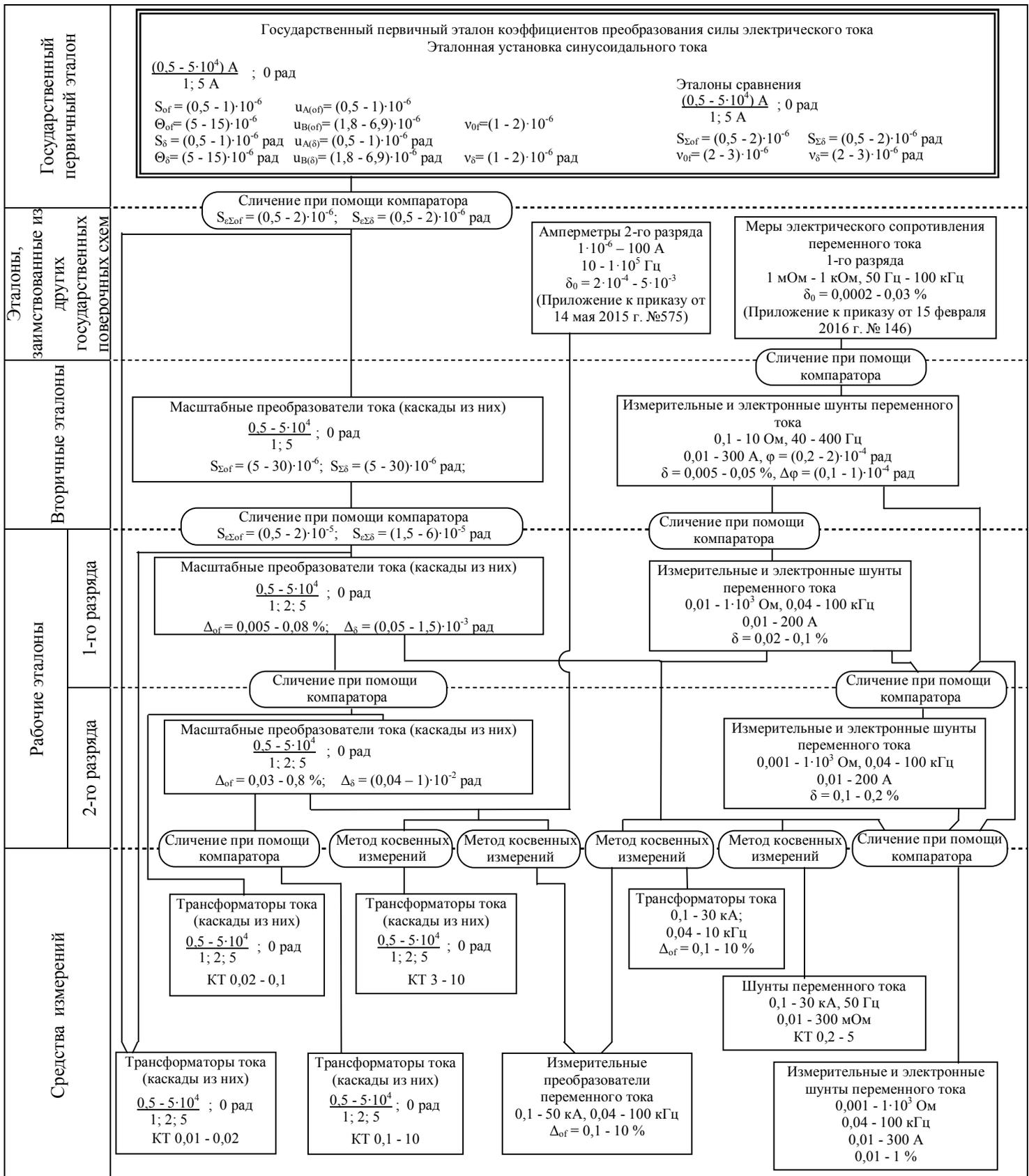
Государственная поверочная схема для средств измерений коэффициентов преобразования силы электрического тока
