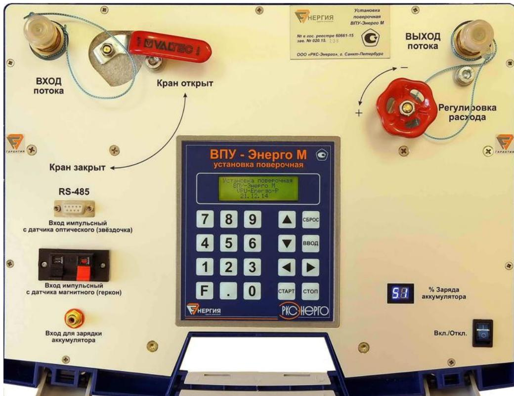
Рисунок 2 – Лицевая панель установки
